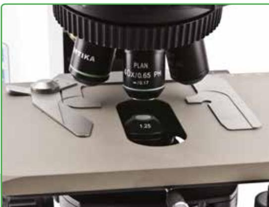
Versión para el análisis de contraste de fases. Iluminación X-LED (potencia 8W).
