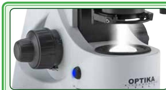
La intensidad de luminosidad se ajusta de forma automática en el microscopio para mantener el nivel de luz que el usuario haya seleccionado tanto si cambia la apertura del diafragma, el tipo de objetivo, la opacidad de la muestra, etc.
