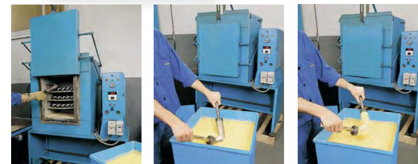
REVESTIMIENTO PLASTICO ANTICORROSIVO
