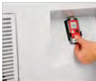
Data Logger con conexión USB
