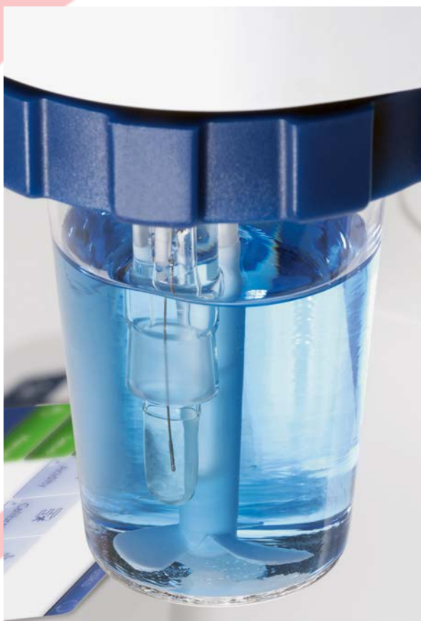
Compact G20S con kit de valoración manual y sensor DGi115-SC en un vaso de valoración de vidrio
