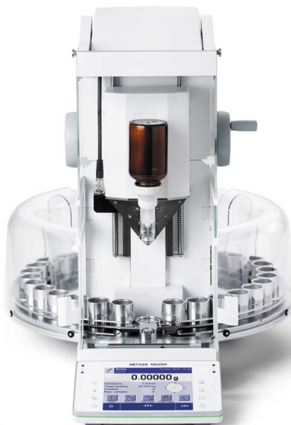
Dosificación automatizada de polvos
