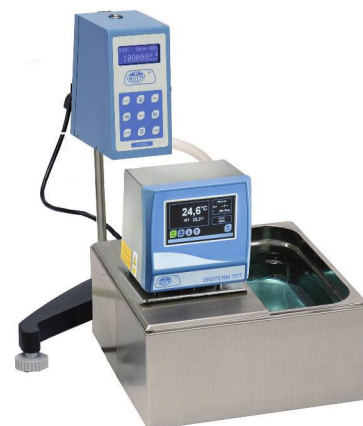
Utilización de un termostato DIGITERM para controlar la temperatura en la medida de viscosidad por medio de recirculación de líquido.
