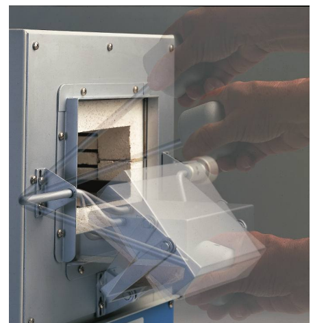
Detalle del sistema de apertura basculante.
